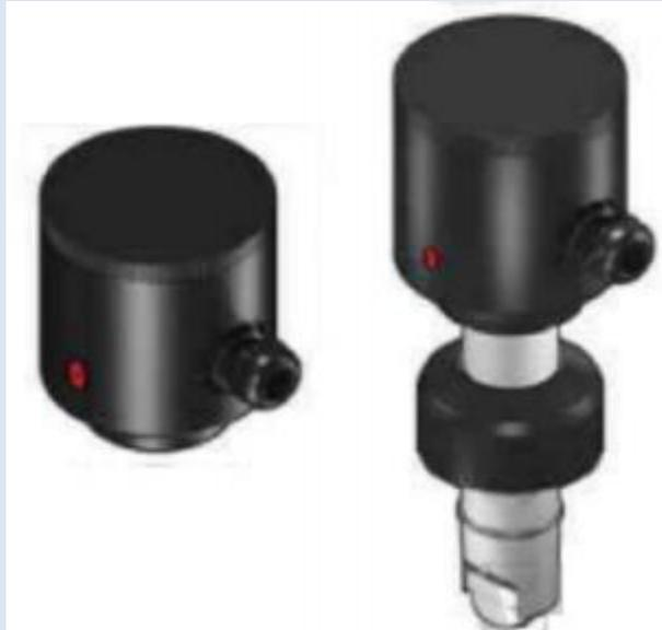
这个套装包含插在传感器上的IP65外壳，里面装备了一个开路集电极频率输出，和一个机械式样SPDT继电器。低警报设定点可以通过微调内置的电位计，随意从 0.15-1m/s (0.5-3.3 ft/s) 调整。当流速低于设定电时，继电器会打开，外壳上的指示灯会变色。
