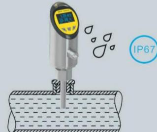
FXW流量温度一体式传感器探头内置温度补偿电路，保证液体温度发生变化时，设定值不会产生漂移。
