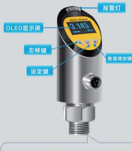
PXW智能型压力变送控制器，OLED显示当前管道压力值或温度值，面板上有三个按键，可以方便设定 压力报警接点和温度报警接点。
